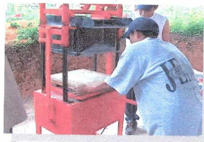
Fig.1a.- Colocación de tarima
